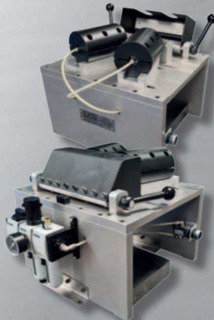
Machine de découpe d'éprouvette
